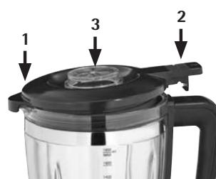
Daarom moet u de uitloop van het deksel altijd zijwaarts tegen de schenkuit van de mengkan plaatsen en het deksel vervolgens voorzichtig op de mengkan (1) drukken. Duw daarna het vergrendelingsmechanisme van het deksel naar beneden tot deze in de handgreep (2) op zijn plaats klikt.
