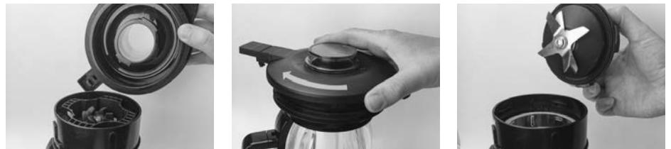
Zur Montage wird zuerst der Dichtring an der Messerbaugruppe angebracht. Achten Sie dabei auf den korrekten Sitz des Dichtrings auf der Messerbaugruppe. Den Bodenverschluss auf den Mixbehälter setzen und gegen den Uhrzeigersinn bis zum Anschlag festdrehen.
